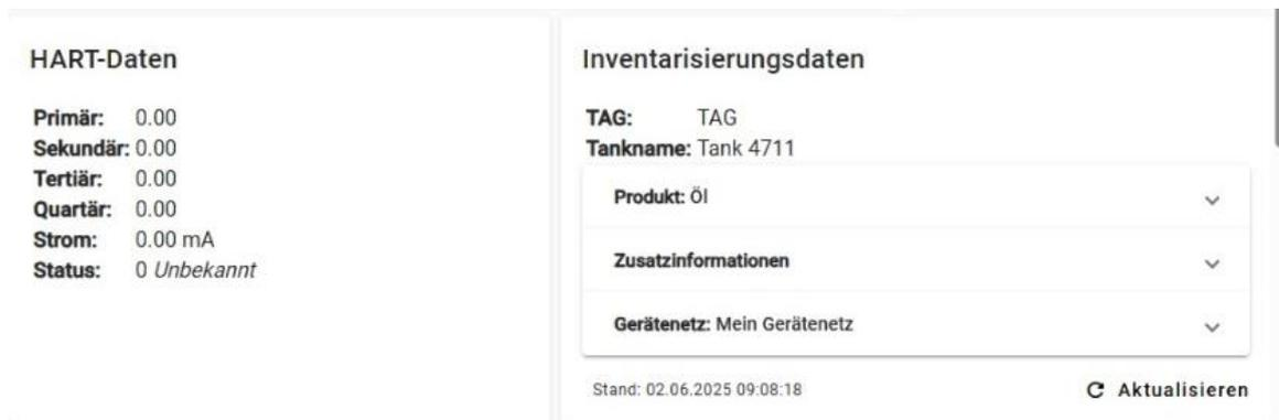
Abbildung 7: HMI - Messstelle - HART- und Inventarisierungsdaten
